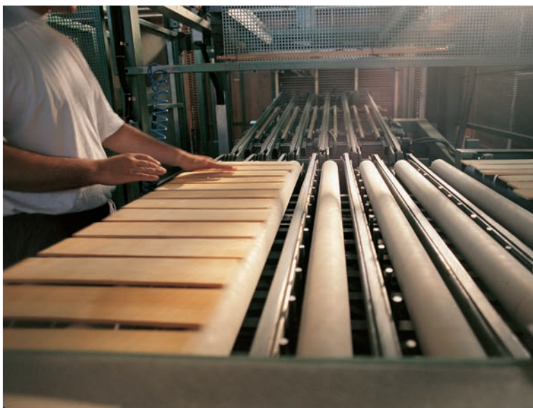
Le support multicouche, véritable cœur technologique du parquet, est composé de cinq à sept sous-couches en contreplaqué de bouleau.
